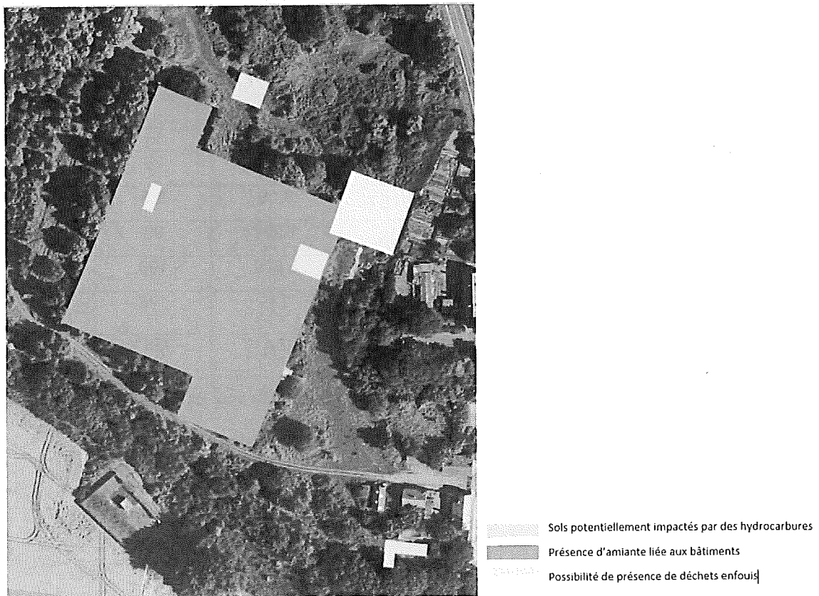
Figure 4 : Localisation des zones présentant des sols potentiellement impactés découvertes lors du chantier de mise en sécurité
